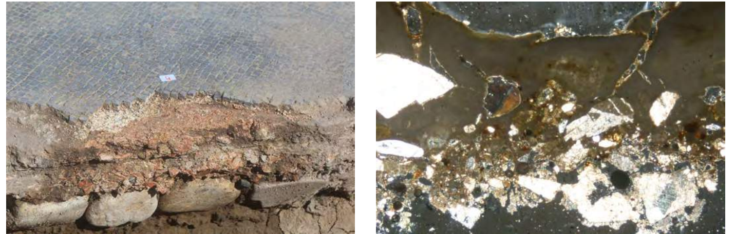
Fig. 5. Unità stratigrafica 378. A sinistra è possibile osservare il susseguirsi dei vari strati, dal basso, acciottolato ( statumen ), strato interno ( rudus ), malta rosata superficiale ( nucleus ) e la malta bianca superiore ( sovrannucleus ) quella cioè a diretto contatto con le tessere musive. La foto a destra è relativa proprio alla maltina bianca superficiale osservata in sezione sottile a 20 X. Si nota, in alto nella foto, la presenza di sola calce, in parte fessurata.
